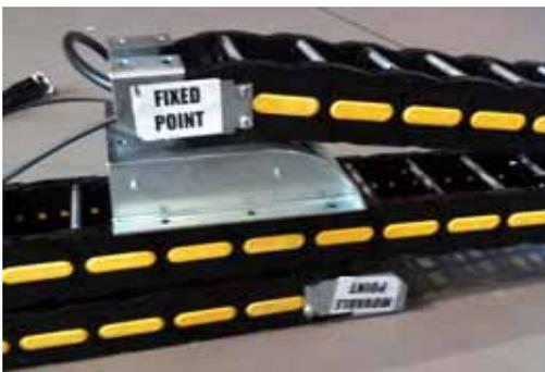
massive Stahlkonsolen für Deckenbefestigung, Kette wird übereinander abgelegt und in Führungskanal eingebettet
