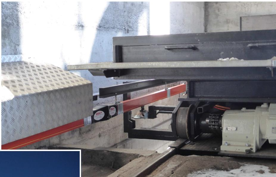
Die komplette Anlage wurde mit der MIBAG-Stromschiene RN7 bestückt.
