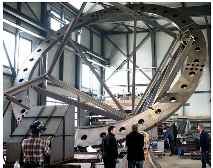
**Massive Stahlkonstruktion Durchmesser 9.6 Meter! Links MIBAG-Schleifringkörper geblockte Ausführung kugelgelagert in stabiler Blechkonstruktion**
