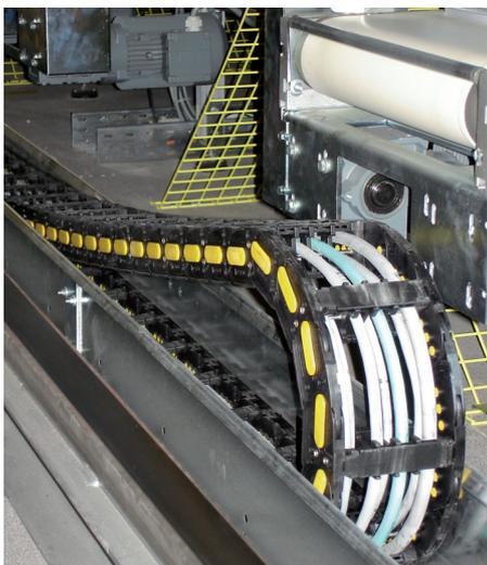
Brevetti-Energieführungsketten sind für lange und kurze Verfahrwege in allen Lagen wirtschaftlich unter extremen Bedingungen einsetzbar.
