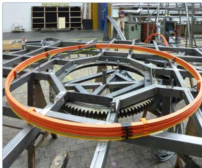
**Plateforme scénique, corps de bagues collectrices incl. fixation et chariot collecteur, délai de livraison court**
