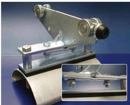
**Chariots de câbles avec soulagement de traction sous forme d'un câble d'acier.** Ainsi, les forces de traction sont distribuées sur le câble métalliques et pas sur le câble plat (vie plus longue et pas de ruptures de toron du câble).
