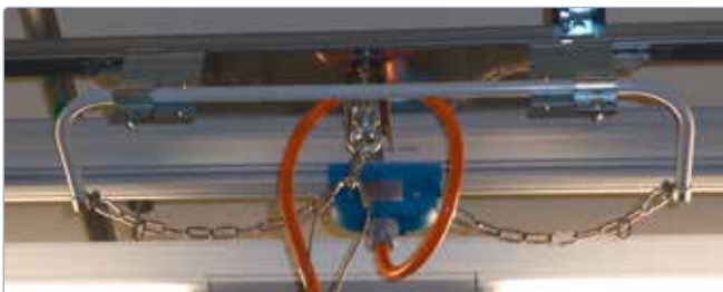
Stinger-System, Schleifleitung in Kombination mit Kabelwagenanlage, C-Profilschiene kann Zug aufnehmen
