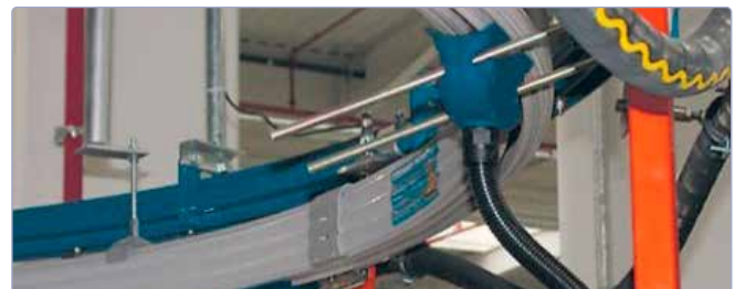
Beispiel Rundanlage, Mitnehmer mit Scharnier pendelnd und seitlichen Abweichungen
