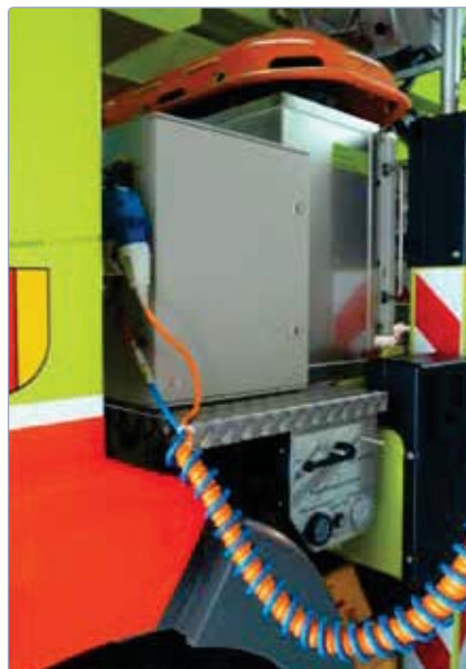
Kombi Leitung für Luft und Strom
