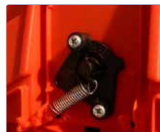
Blocage du câble à la longueur désirée
