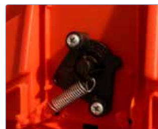
Blocage du câble à la longueur désirée
