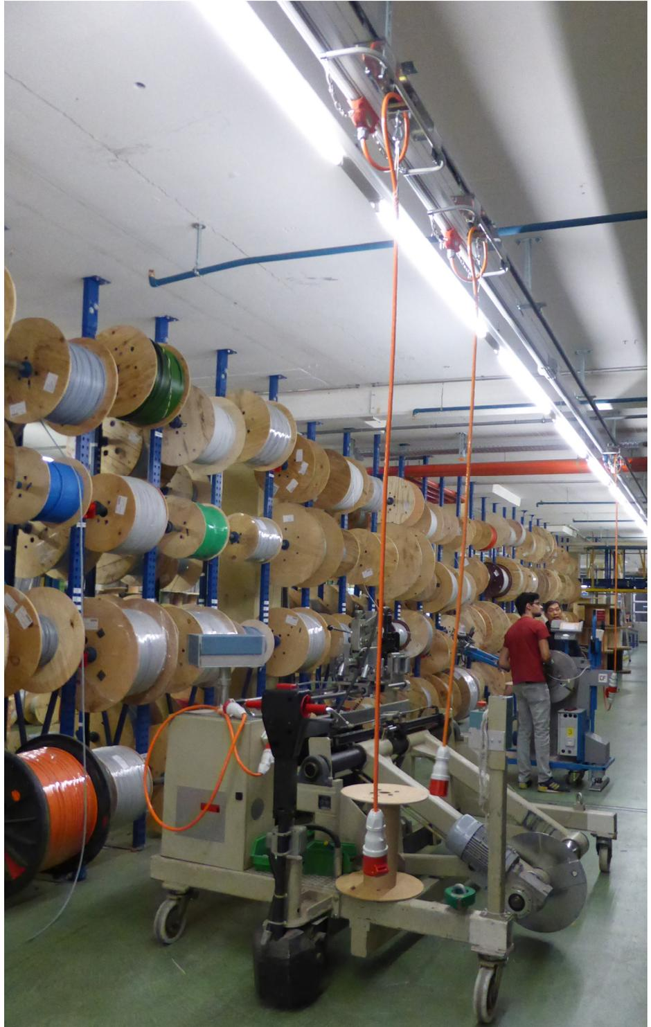
Wirtschaftliche Lösung für parallel geführte Systeme, projektbezogen und kundenspezifisch mit MIBAG-Standardelementen gefertigt, Einsatz z.B. in Kabellager, ergonomische Arbeitsplätze, Betonwagen etc.
