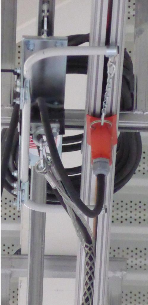
Die Schleifleitung als Hauptstromzufuhr wird parallel zum Kabelwagen-System montiert.
