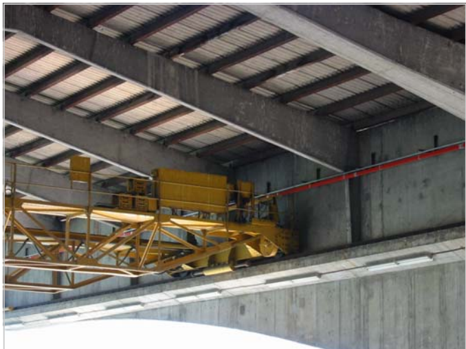
Auhafen Basel - Umschlag von Rheinschiffen 95 m Anlage für 320 A für Schiffsentladekran, 2-3 schichtiger Einsatz
