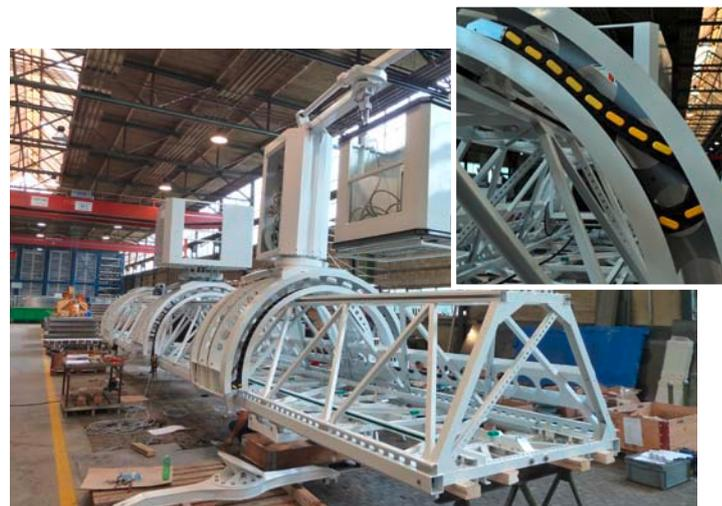
Fassadenbefahranlage mit drei verschiebbaren Einheiten, um jede Position an der Kuppe anfahren zu können
