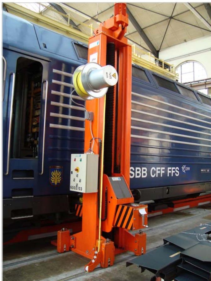
SBB-Hauptwerkstätte - verschiebbare Hubsäulen mit H+K Federleitungstrommel für die ergonomische und sichere Ausführung von Wartungsarbeiten an den SBB-Loks
