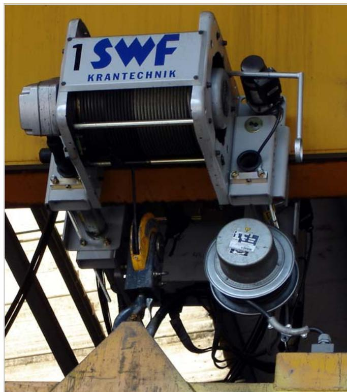
**Federleitungstrommel für Magnetansteuerung**
