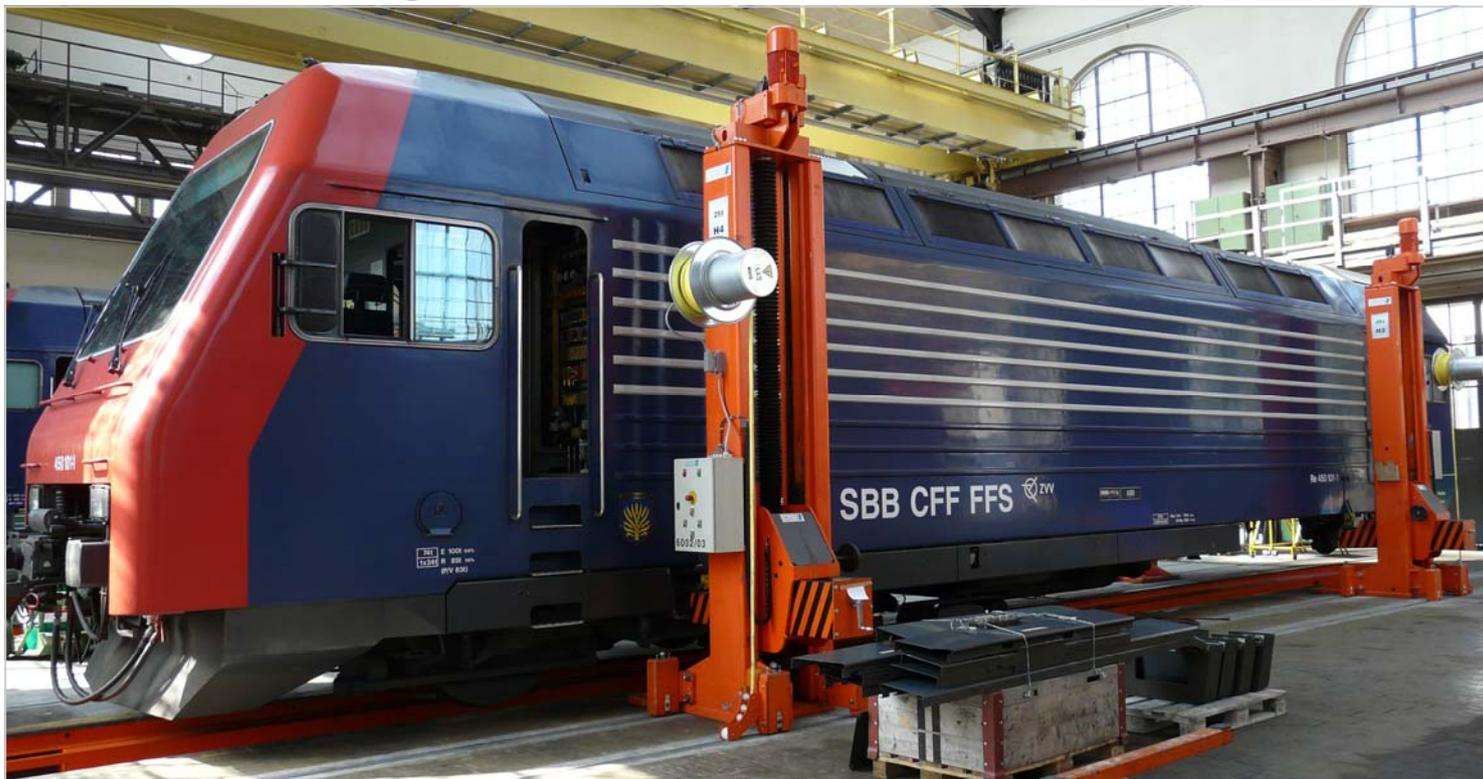
**SBB-Hauptwerkstätte - verschiebbare Hubsäulen mit H+K Federleitungstrommel**
