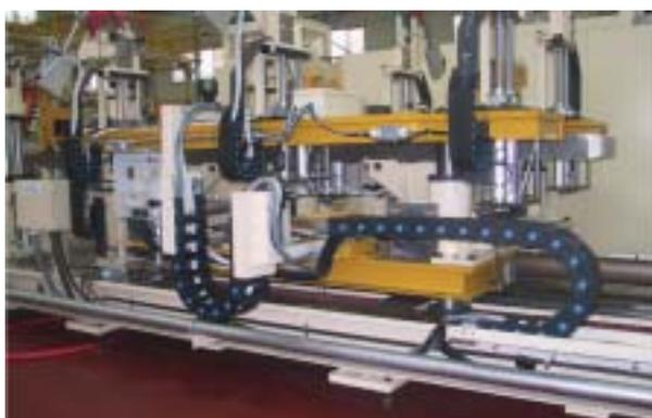
Das ausgeklügelte Programm von Energieführungsketten, sowohl aus Kunststoff als auch aus Metall, hat vielfältige Anwendungsmöglichkeiten, von den automatischen Drehbänken bis zu den Bohrinseln.
