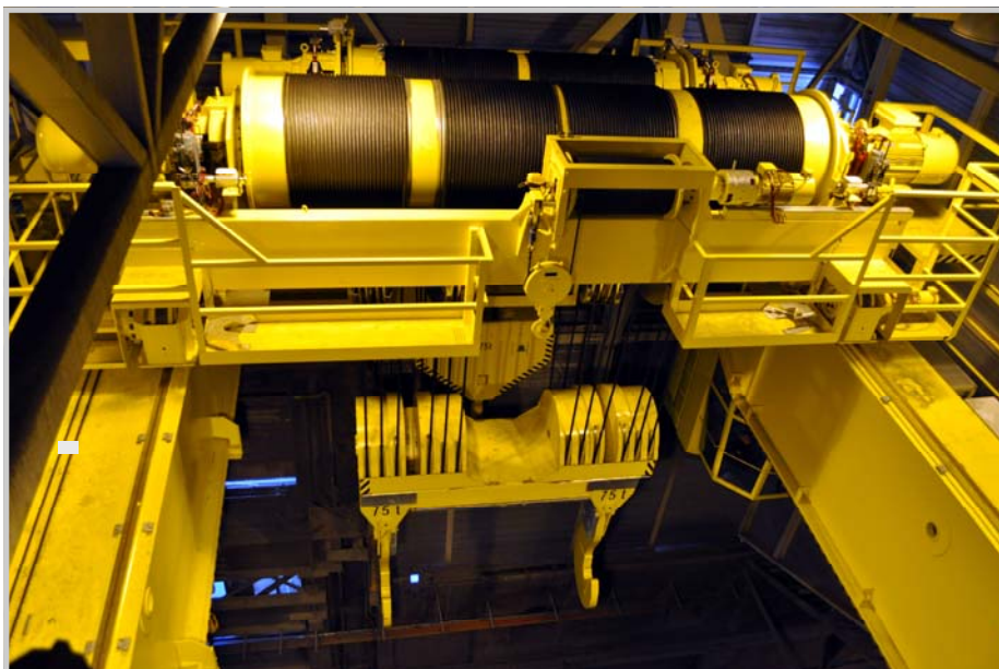
Seiltrommel mit Haken für 150 Tonnen!
