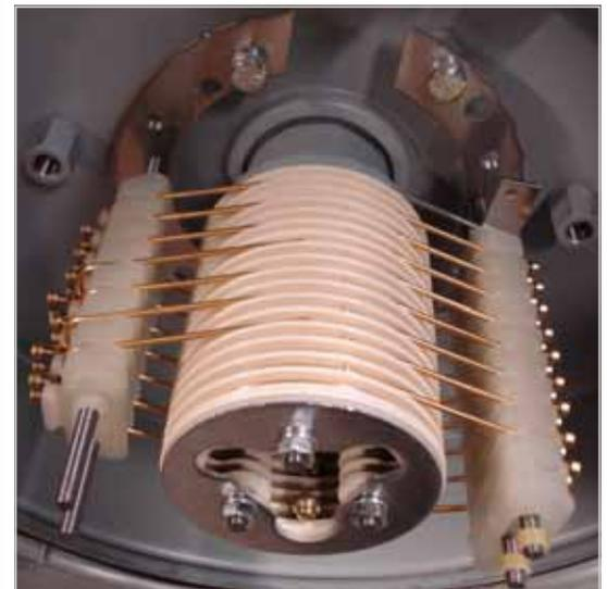
geblockt, Schutzart IP 00, Typenreihe YB26A und YB32A, mit Pendelbürstenhalter, in massiver Blechausführung
