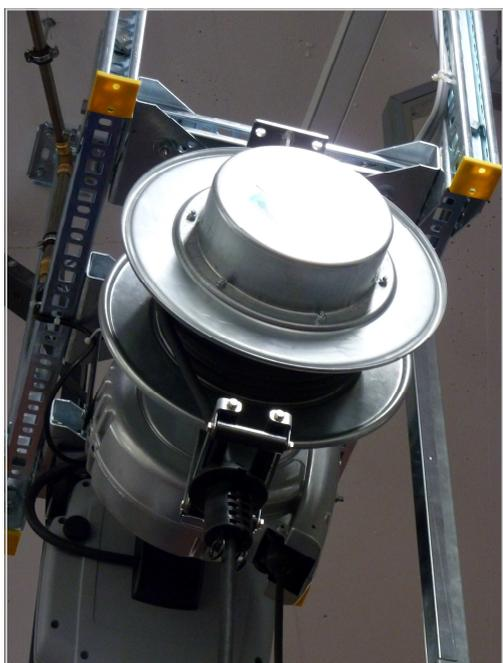
**Massive Stahlausführung mit Deckenhalter, Raste und schwenbarer Rollenführung sowie einem in der Höhe verstellbaren Kabelstopper**
