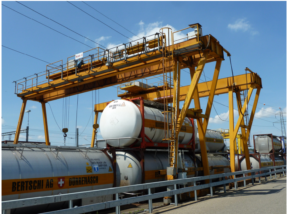
Ständerkonstruktion in massiver Stahlausführung mit Gleitauhängungen
