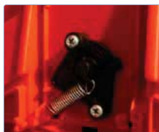
Blocage du câble à la longueur désirée
