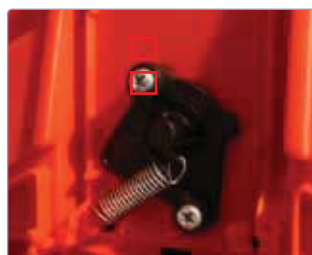
Blocage du câble à la longueur désirée
